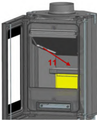
11: Poser le réfractaire bas sur la sole foyer et contre le fond
